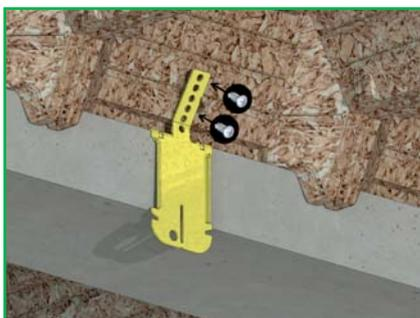
Appliquer la languette contre la sous face de l'EBM, fixer la suspente, à l'aide de 2 vis\*, directement dans l'EBM en la maintenant sur le talon de la poutrelle.
